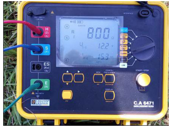
Figura 10. Lectura instrumental muy elevada (800 Ohmios), en terreno baldío en el reparto Celimar, municipio Habana del Este, denotando elevada probabilidad de una sala subterránea (caverna) de grandes proporciones a los 14 m de profundidad desde la superficie. Fuente: original de los autores, 2024.
