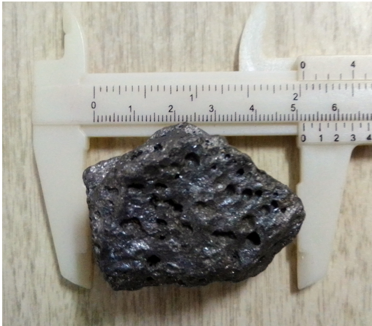
Fig. 1. Pequeñas estructuras con aparente aspecto de regmagliptos, en la superficie del objeto metálico de 119 g, hallado en febrero de 1996 cerca de Calabazar, Boyeros, La Habana, erróneamente clasificado como meteorito (Foto del autor principal, 2023).
