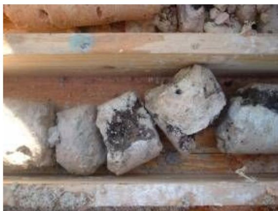
Foto 1. Calizas carsificadas, con índices de flujo de hidrocarburos por las oquedades. Zona de Puerto Escondido
