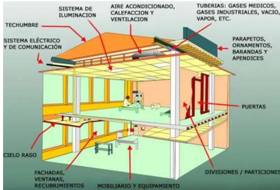
Fig. 1. Elementos no estructurales en instalaciones hospitalarias.
