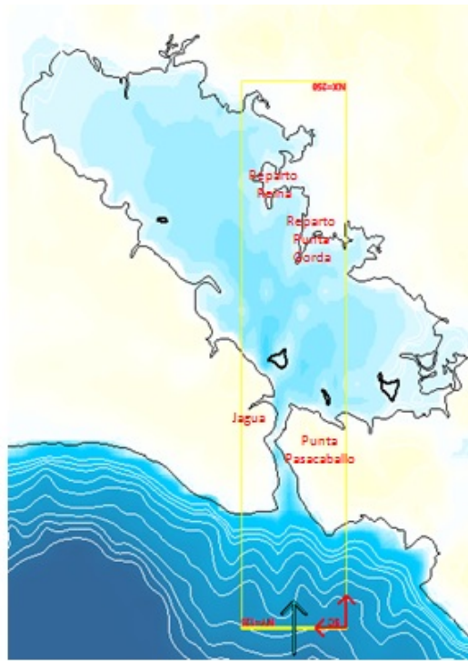
Fig.2. Malla de cálculo dispuesta sobre el canal de entrada y sector central de la bahía de Cienfuegos.
