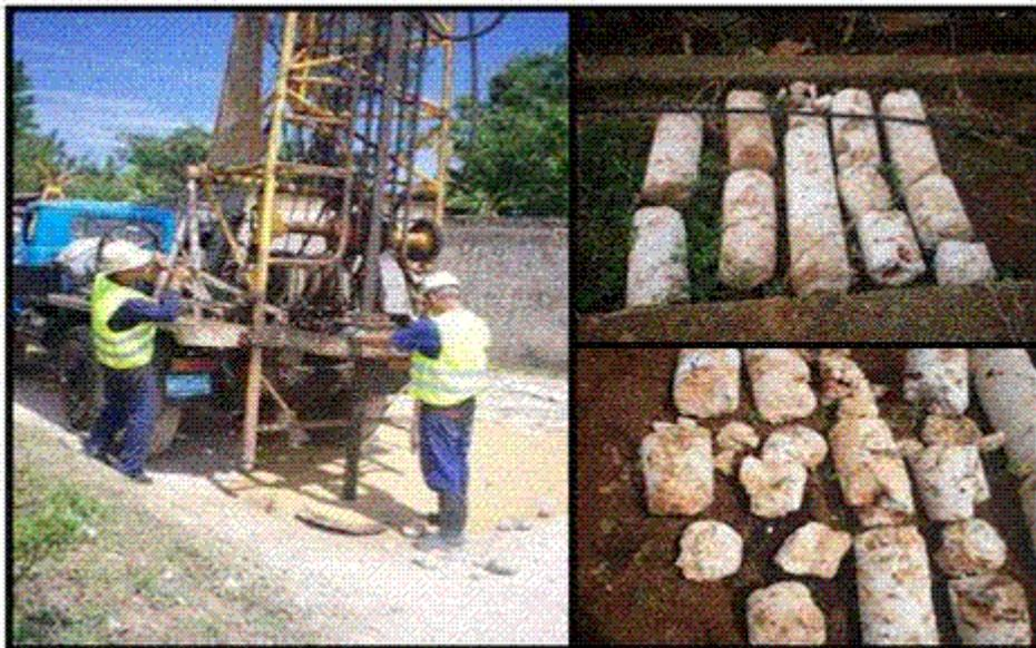
**Fig.2 Máquina perforadora utilizada y recuperación de testigos de perforación**
